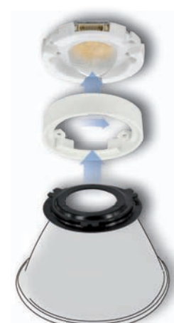
Fortimo™ SLM Modul mit CLE Dreh- und Click Ringadapter und Reflektor
